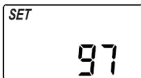
**Автоматическое включение регенерации немедленно после использования емкости фильтроэлемента на 97%.**
