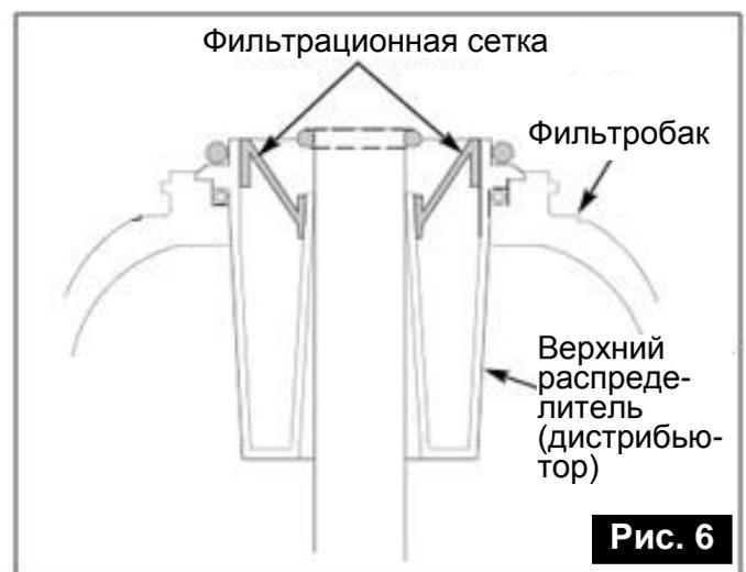
Активирование функции дополнительной очистки CLEAN ON позволяет автоматически удалять загрязнения с фильтрационной сетки перед каждой регенерацией.
