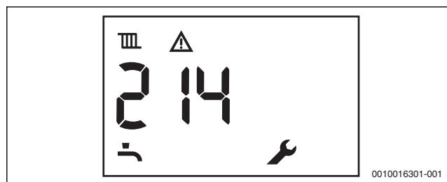
Rys. 69 Przykład: usterka niepowodująca blokady
